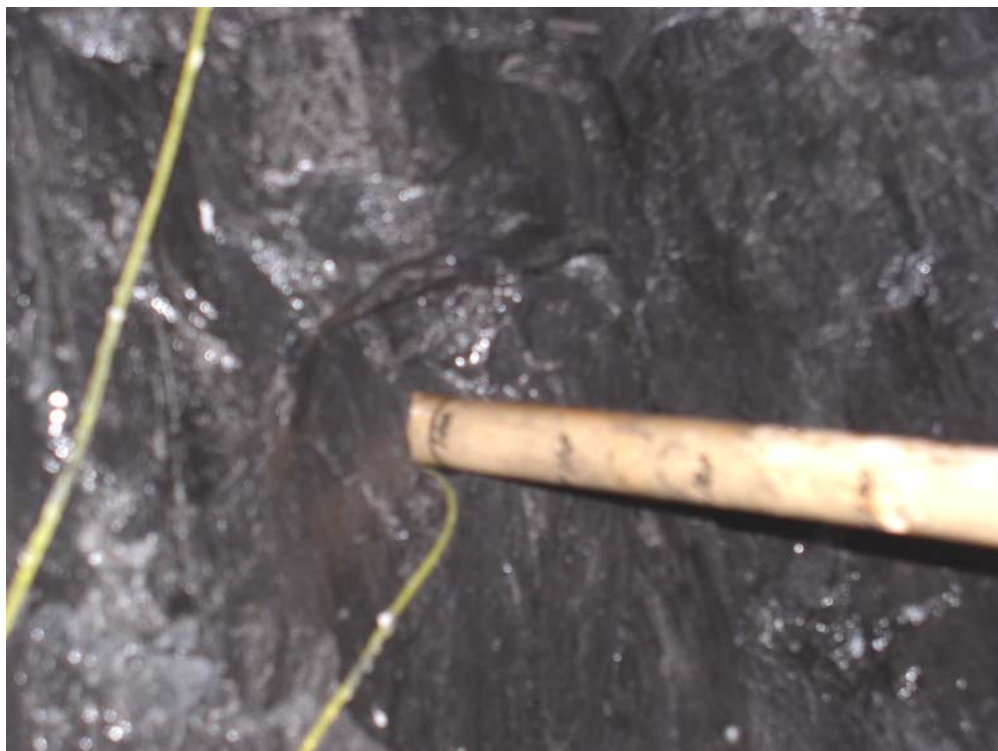
Foto 8.2.1. Mätning av avladdning med laddkäpp - Björnböle
