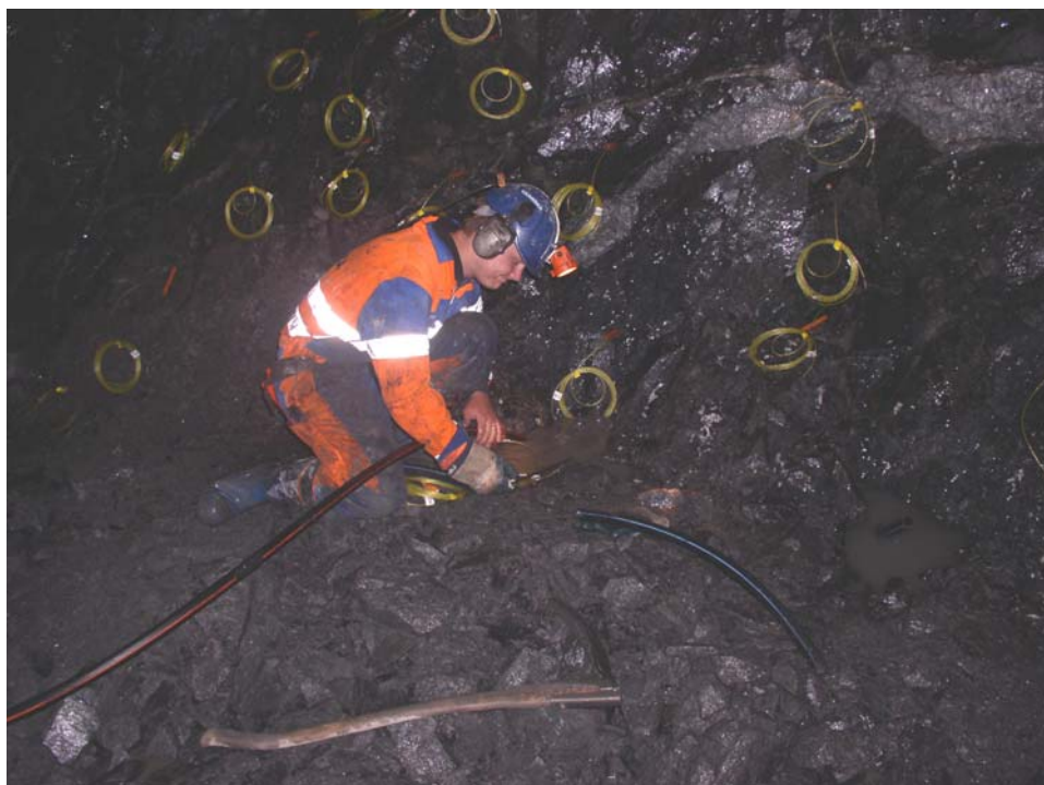
Foto 8.1.3. SSE i bottenhål genom slang - Björnböle
